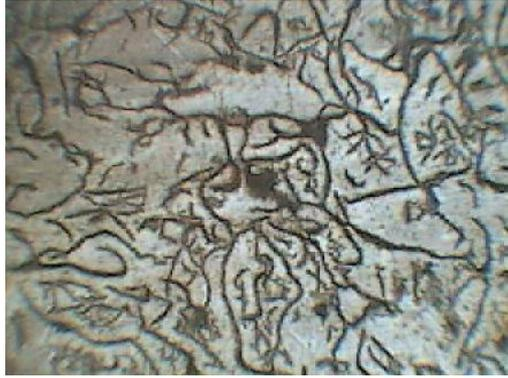
**Figura 7.1 – Ferro Fundido Recozido (ampliação de 50X)**
