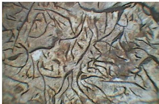
**Figura 7 – Ferro Fundido Testemunha (ampliação de 50X)
