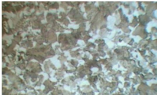
**Figura 5.1 – 1060 Recozida (ampliação de 50X)**
