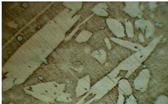
**Figura 9.1 – Latão Recozido (ampliação de 50X)**
