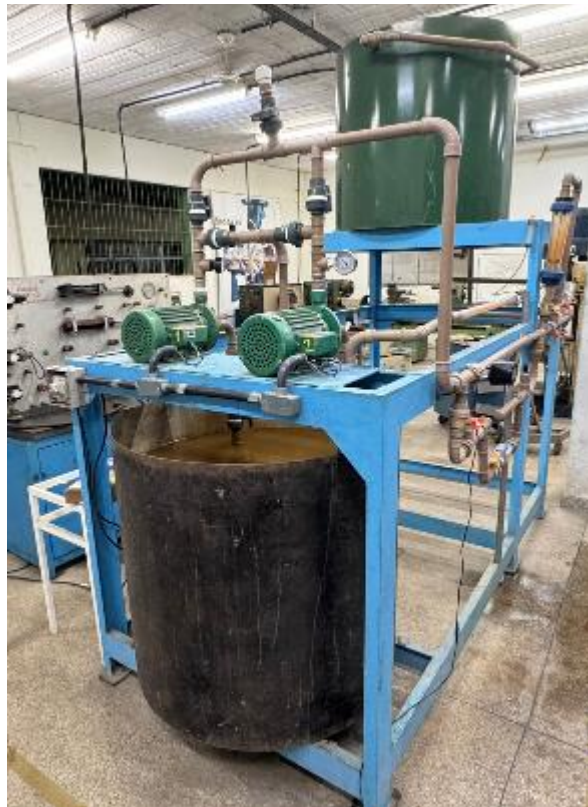
Figura 14 - Bancada hidráulica revitalizada.
