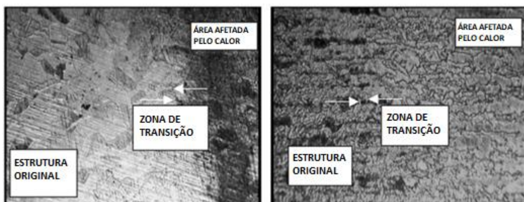
Figura 12 - Área afetada pelo calor e zona de transição do corte da amostra
