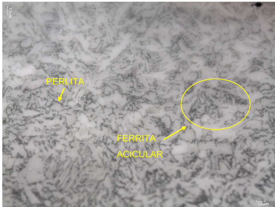
Figura 32 - Microestruturas da face de corte da amostra 5
