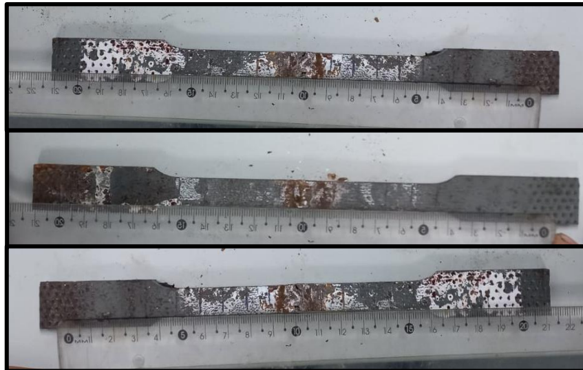
Figura 18 – Resultado dos corpos de prova (Eletrodo) após ensaio de tração
