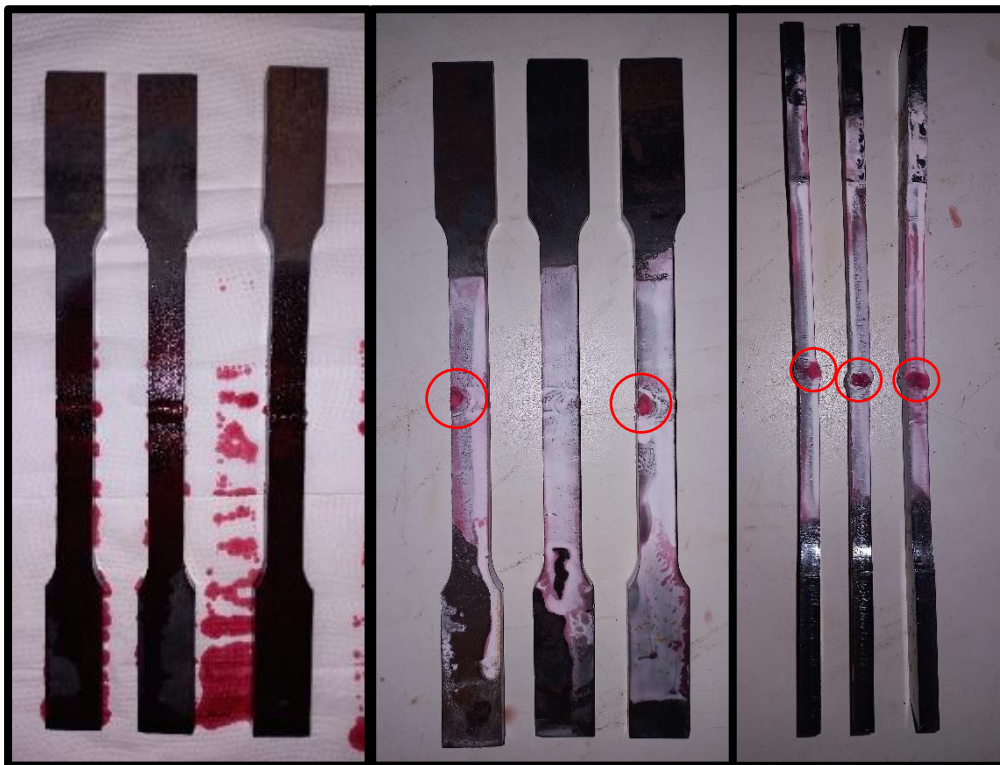
Figura 17 – Líquido penetrante na soldagem por eletrodo
