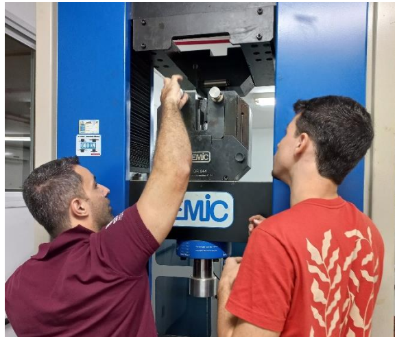
Figura 15 – Instalação dos corpos de prova na máquina de tração
