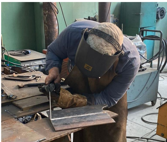
Figura 9 – Aplicação da soldagem por eletrodo
