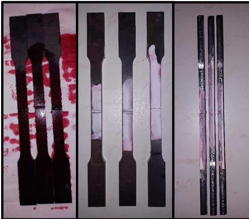
Figura 16 – Líquido penetrante na soldagem a laser
